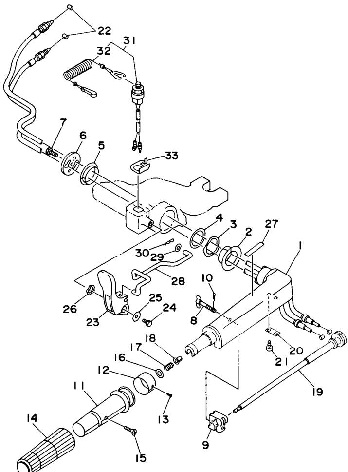
FIG. 11 STEERING DIRECCION
