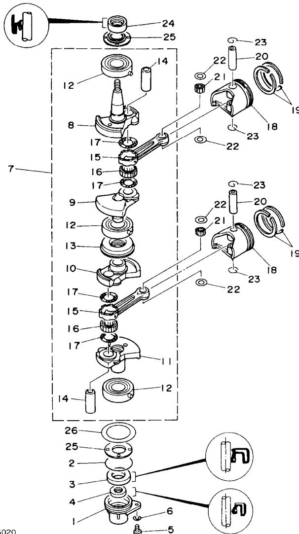
**FIG. 2 CRANKSHAFT. PISTON**      **CIGUENAL. PISTON**
