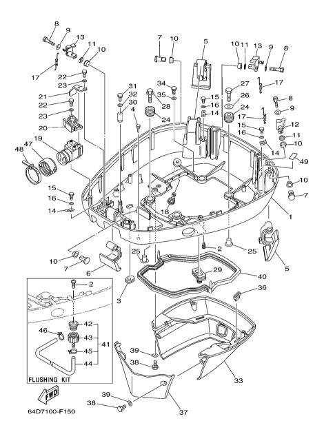
FIG. 15 BOTTOM COWLING
