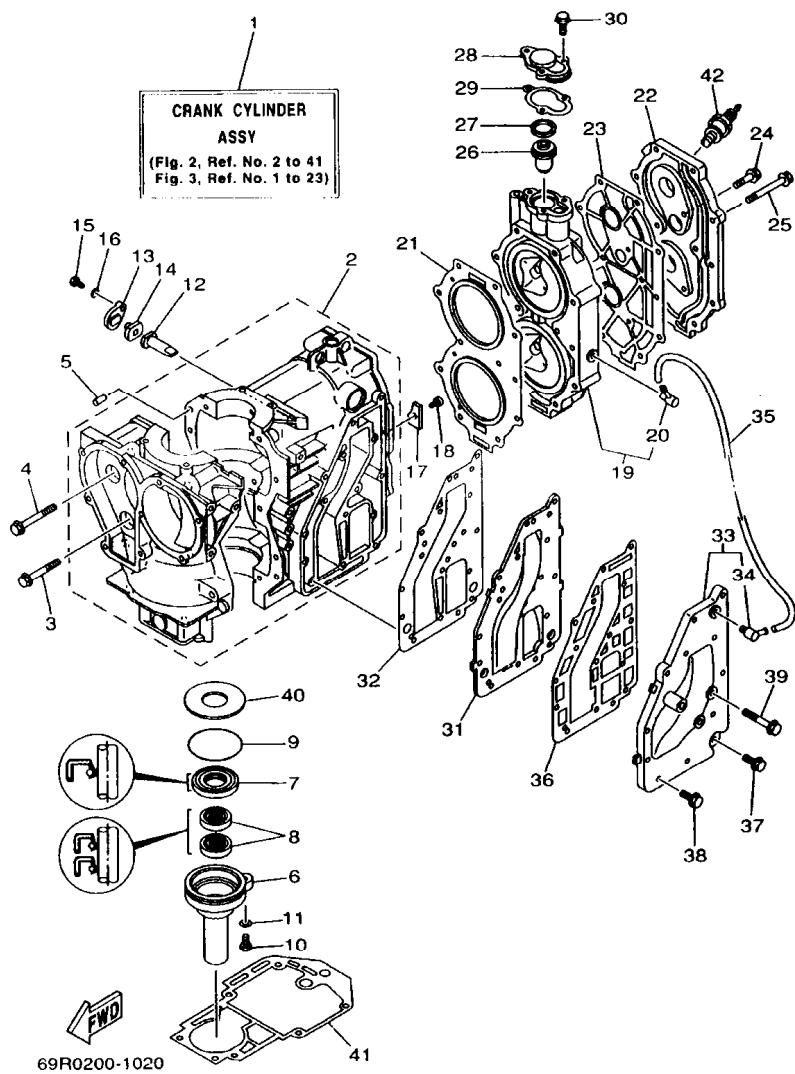
**FIG. 2 CYLINDER. CRANKCASE**
