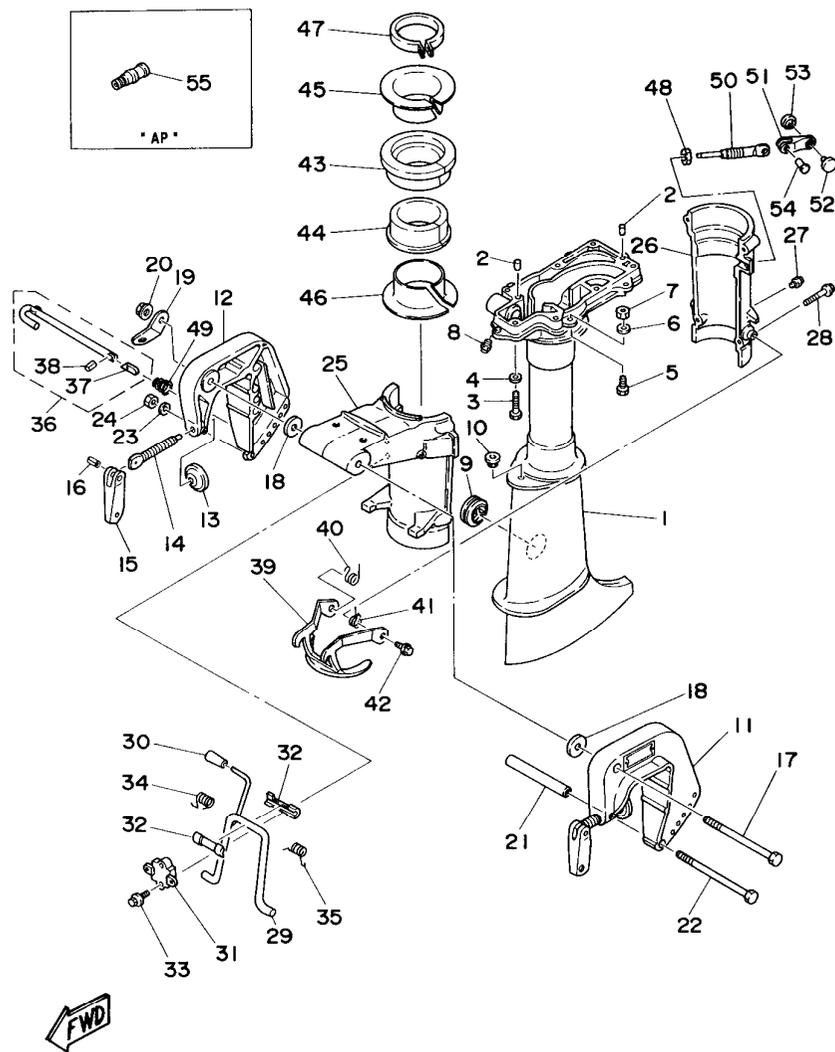
FIG. 6 UPPER CASING. BRACKET CUBIERTA SUPERIOR Y SOPORTE
