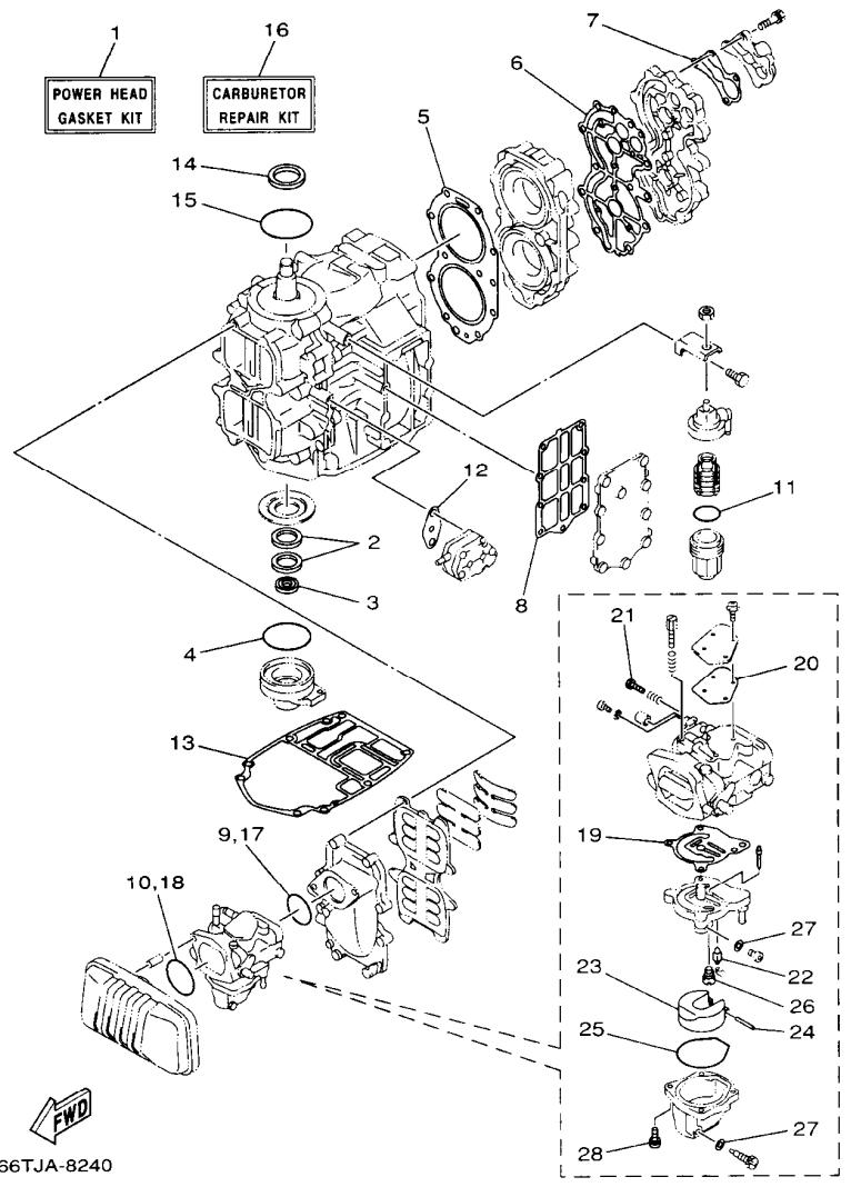
**FIG. 30 REPAIR KIT 1**      **ESTUCHE REPARACION 1**
