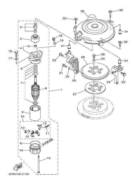
FIG. 14 STARTING MOTOR
