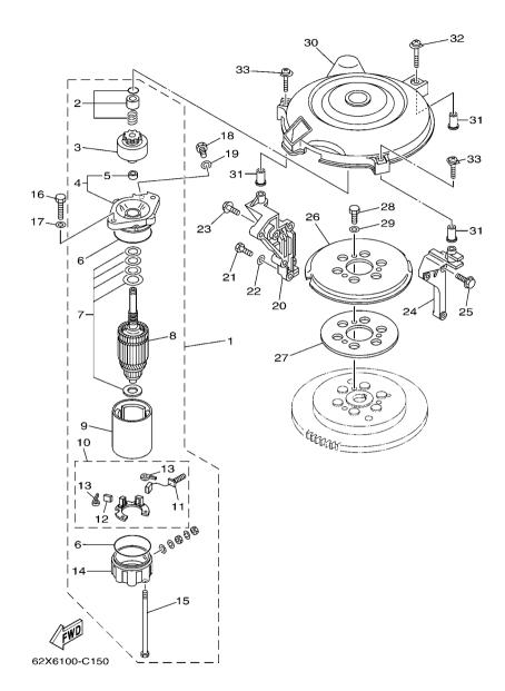
FIG. 14 STARTING MOTOR
