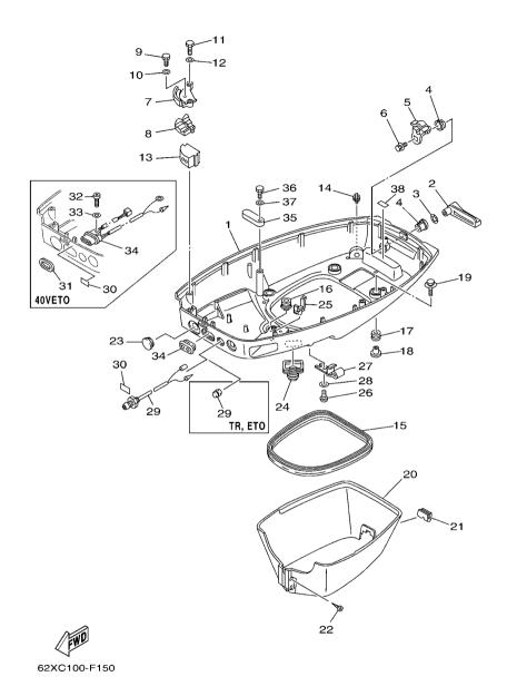
FIG. 15 BOTTOM COWLING
