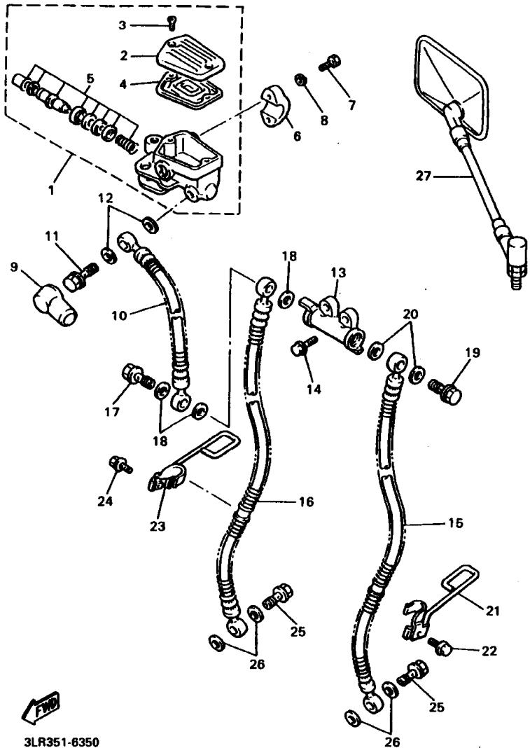
**FIG. 35 FRONT MASTER CYLINDER**
