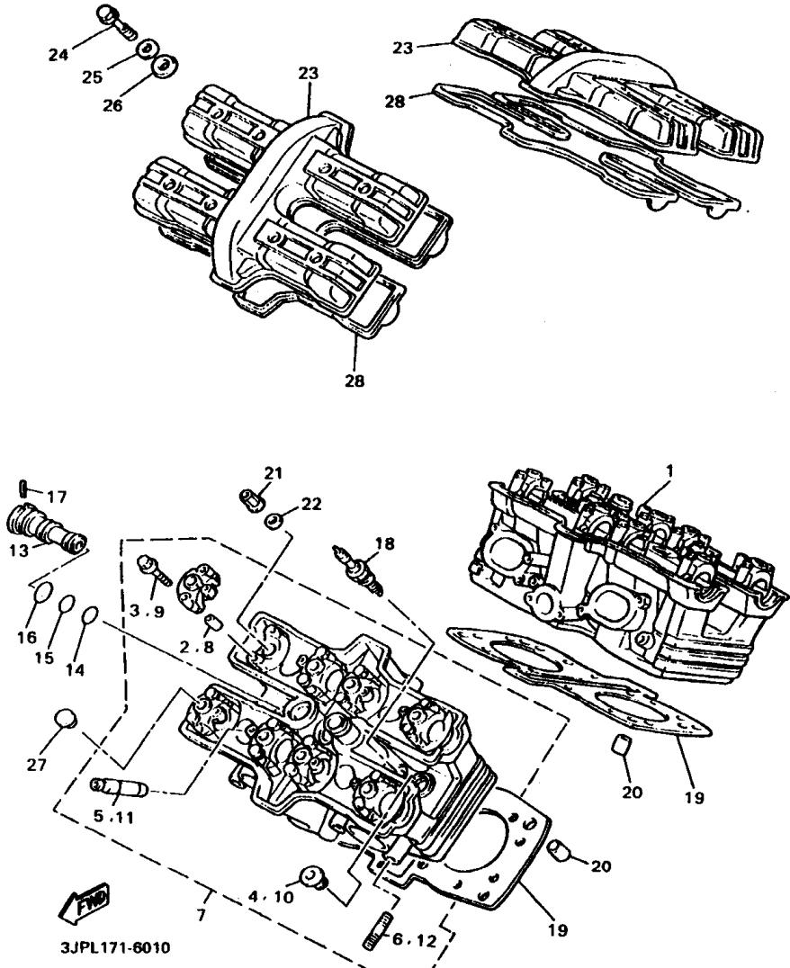
**FIG. 1 CYLINDER HEAD**
