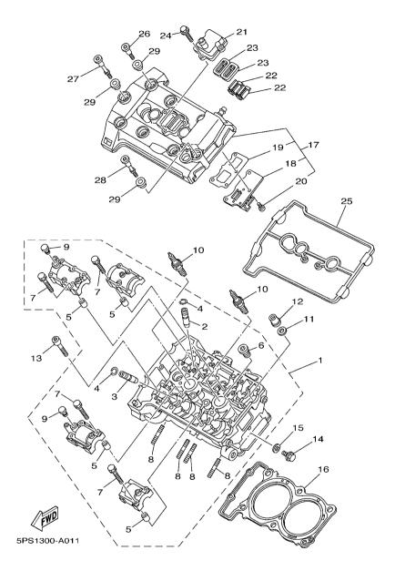
FIG. 1 CYLINDER HEAD
