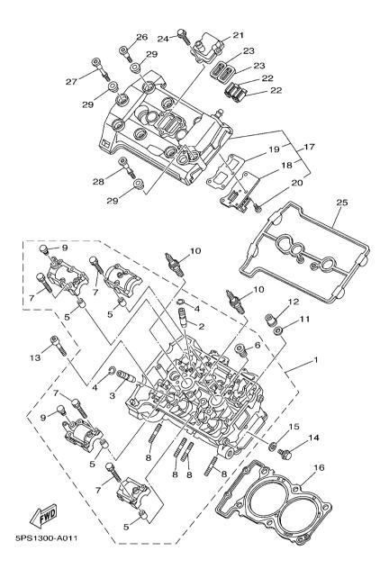
FIG. 1 CYLINDER HEAD
