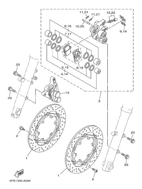
FIG. 29 FRONT BRAKE CALIPER
