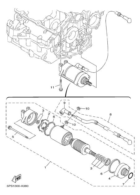
FIG. 38 STARTING MOTOR
