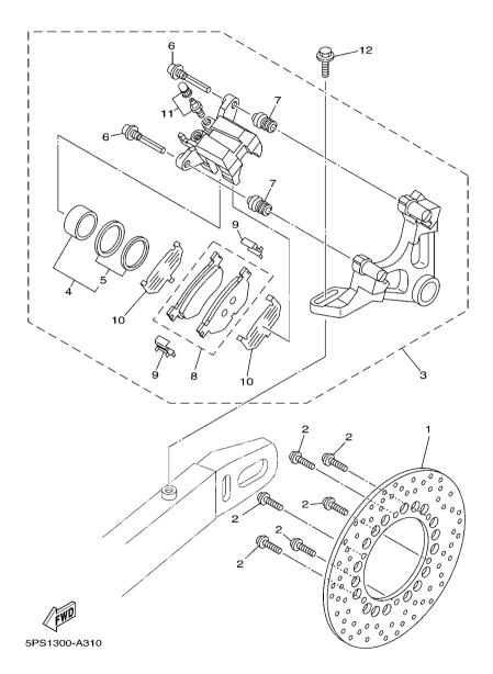
FIG. 31 REAR BRAKE CALIPER
