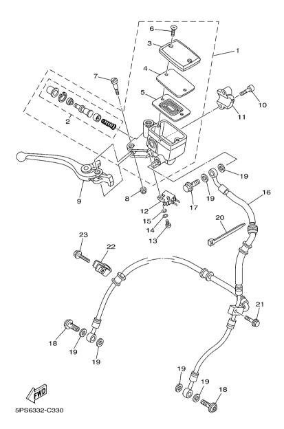
FIG. 33 FRONT MASTER CYLINDER
