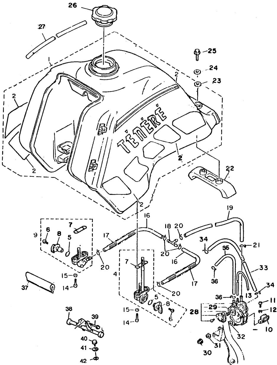
FIG.24 – TANQUE DE GASOLINA
