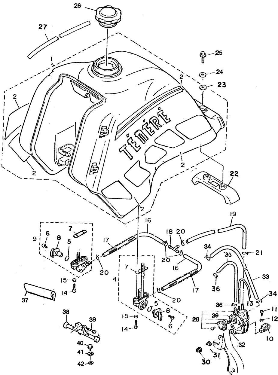
FIG. 24 - TANQUE DE GASOLINA
