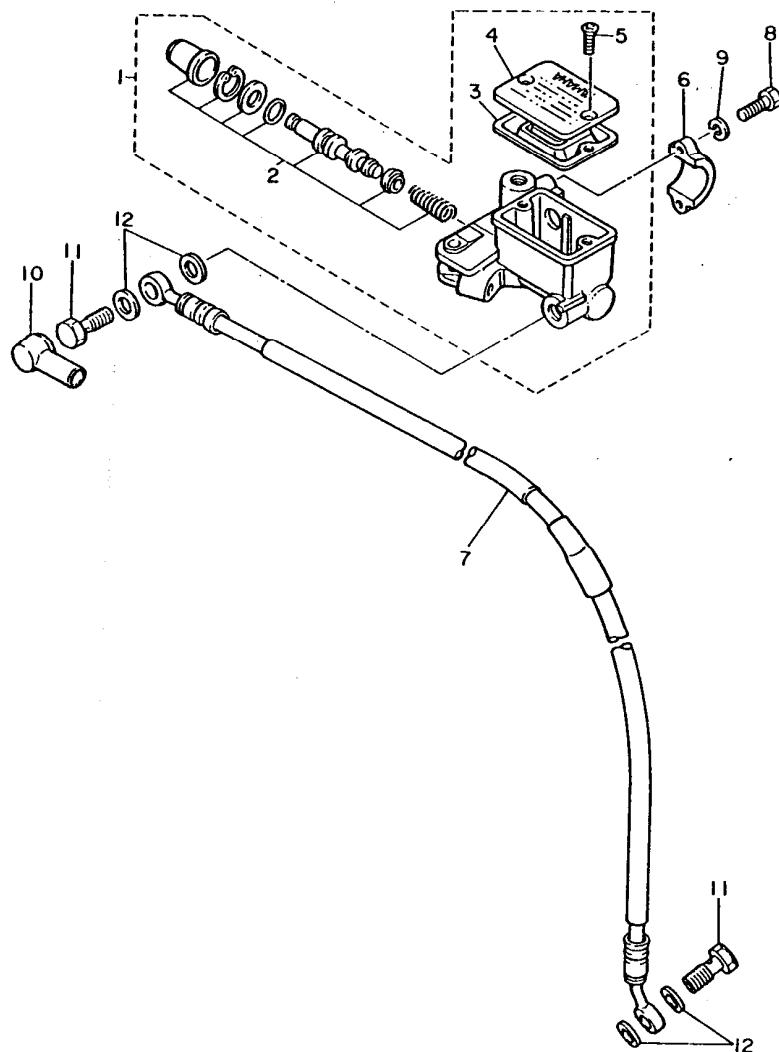
FIG. 29 - CILINDRO MESTRE DO FREIO
