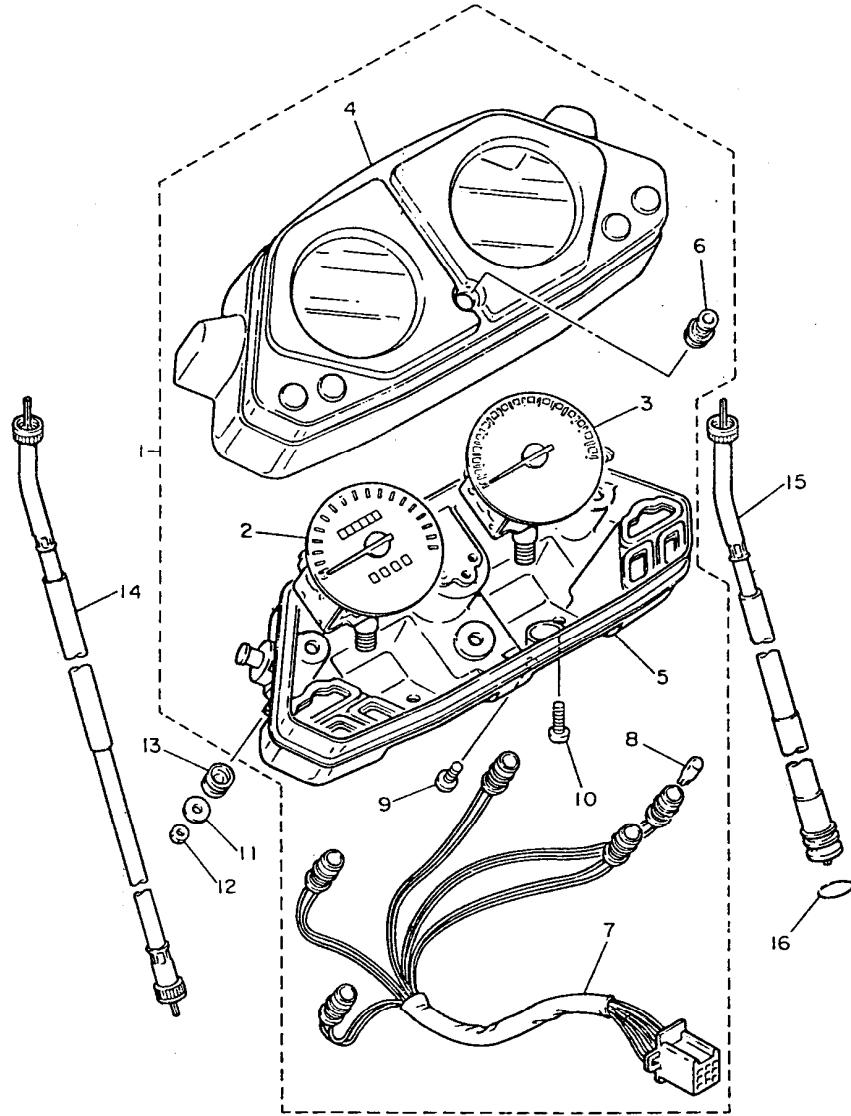
FIG. 34 – VELOCÍMETRO E TACÔMETRO
