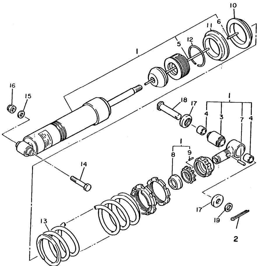
FIG. 21 - AMORTECEDOR TRASEIRO
