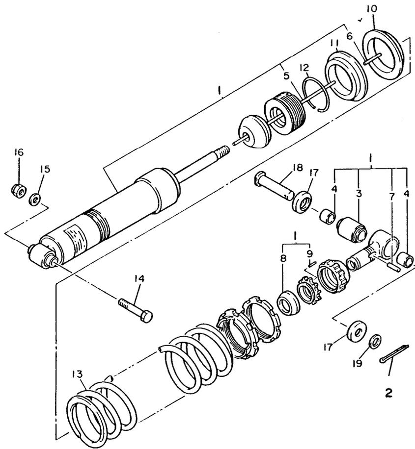
FIG. 21 - AMORTECEDOR TRASEIRO
