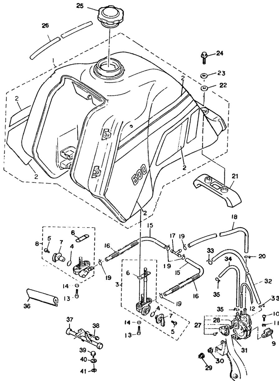
FIG. 24 - TANQUE DE GASOLINA
