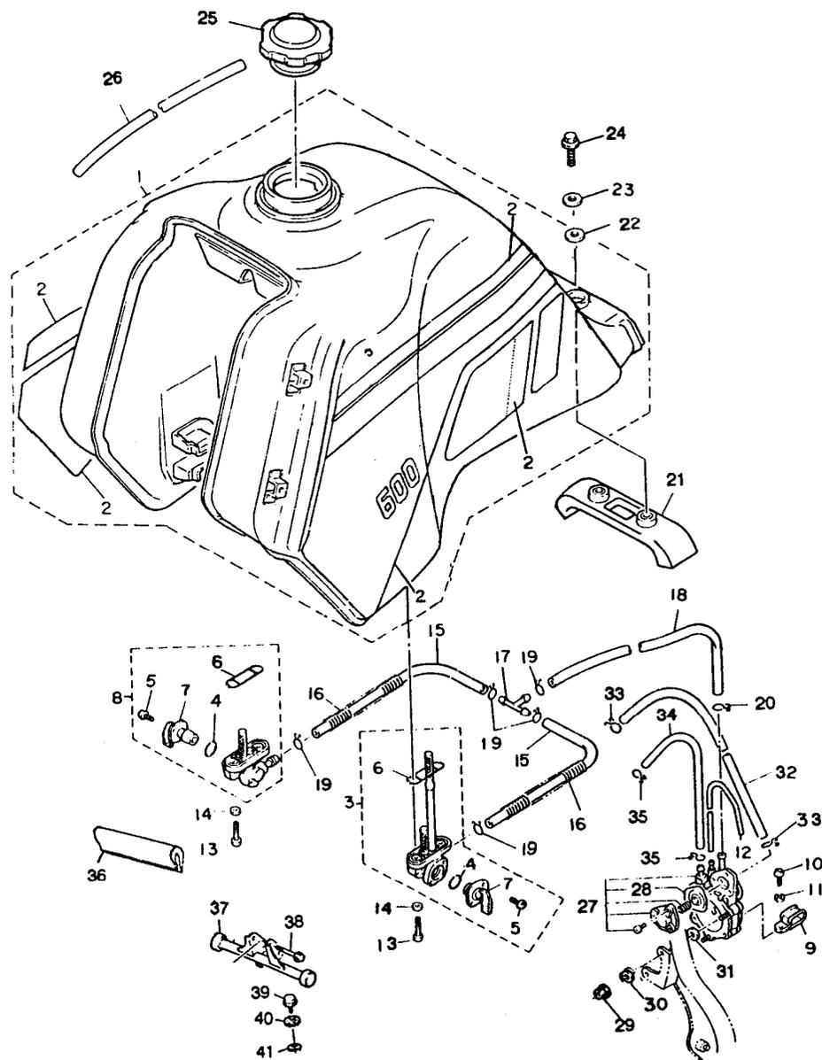
FIG. 24 - TANQUE DE GASOLINA (Cont.)
