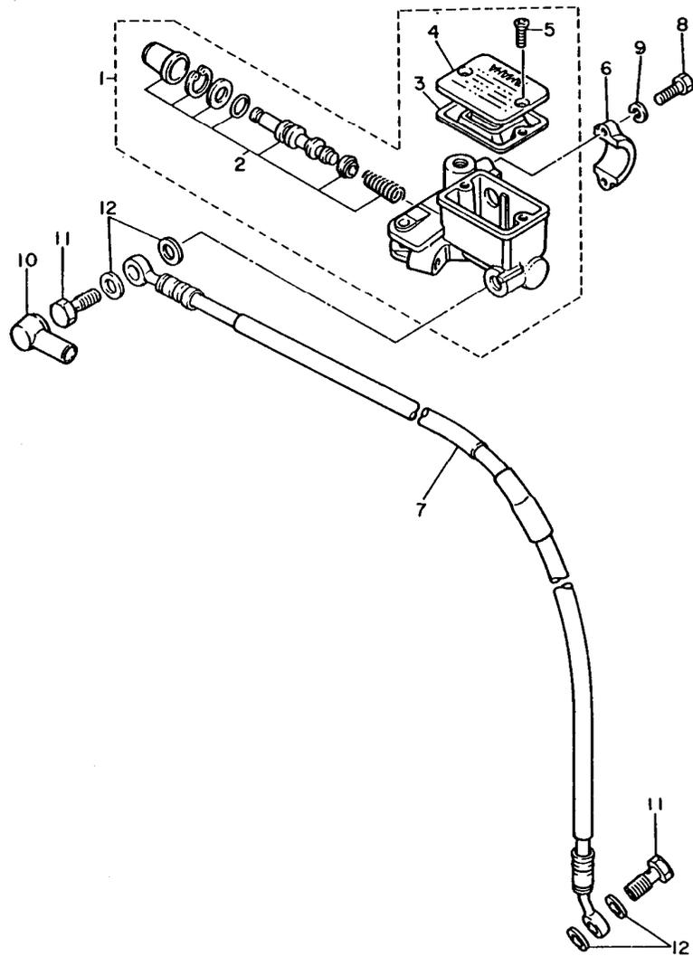
FIG. 29 - CILINDRO MESTRE DO FREIO
