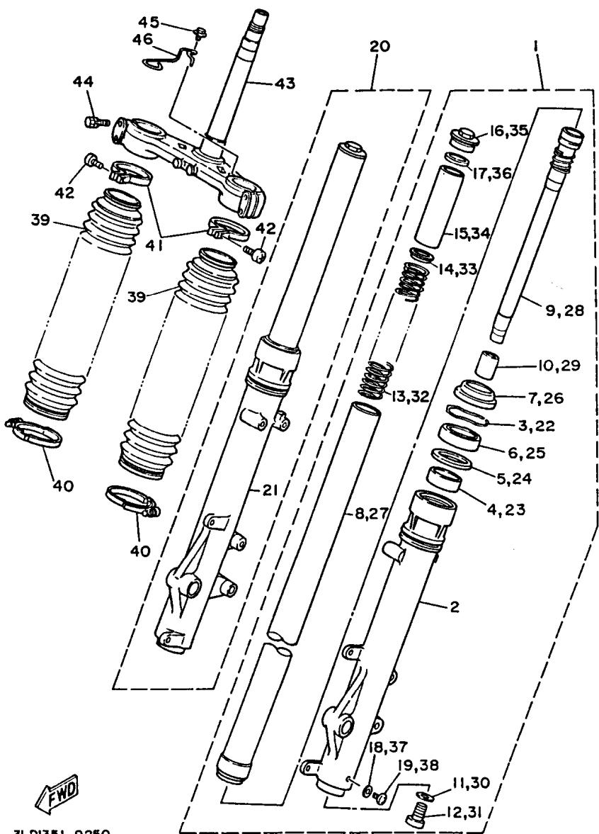
FIG. 25 HORQUILLA DELANTERA
