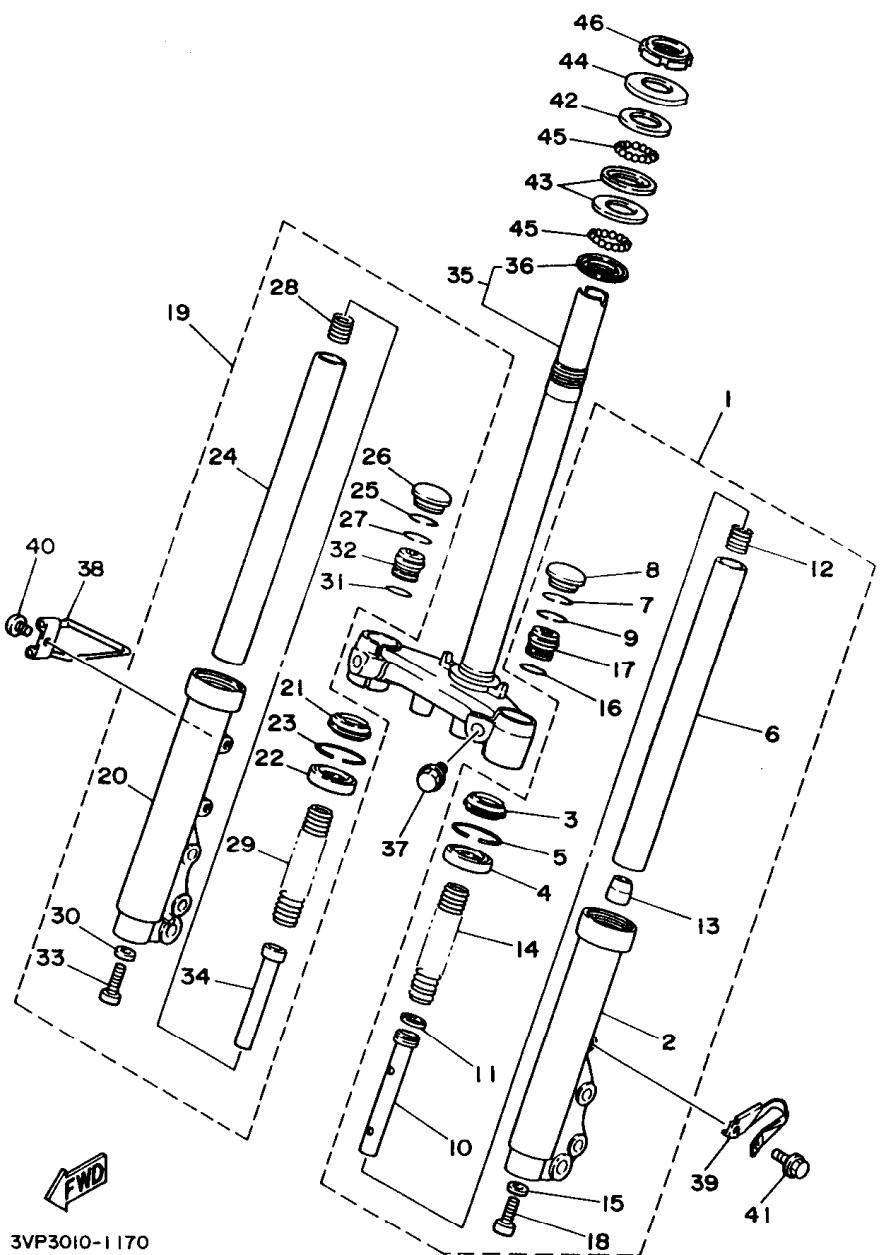
FIG. 17 HORQUILLA DELANTERA
