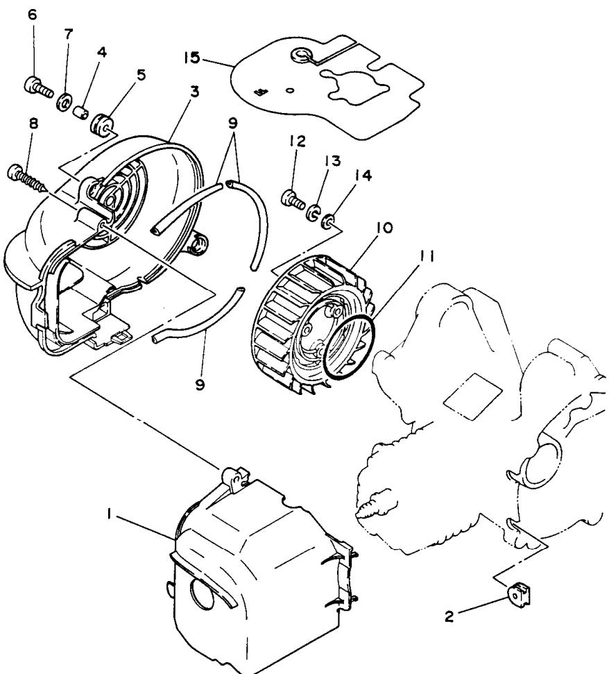
FIG. 3 CUBIERTA DE AIRE. VENTILADOR AIR SHROUD. FAN
