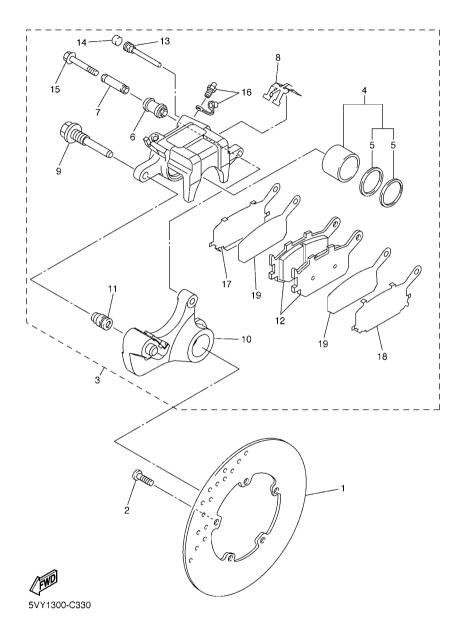
FIG. 33 REAR BRAKE CALIPER
