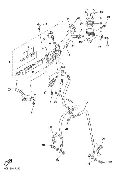
FIG. 35 FRONT MASTER CYLINDER
