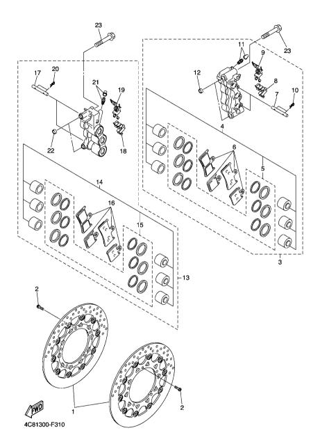
FIG. 31 FRONT BRAKE CALIPER
