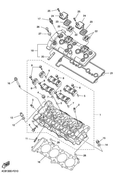
FIG. 1 CYLINDER HEAD
