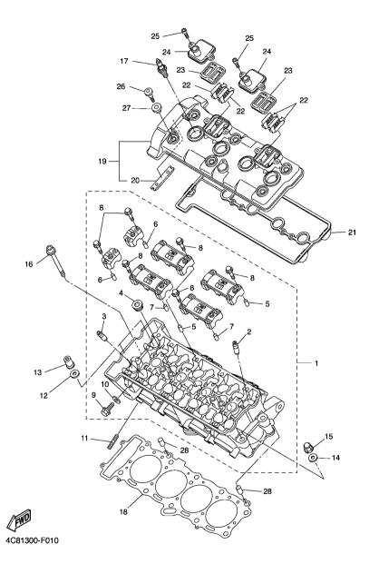
FIG. 1 CYLINDER HEAD
