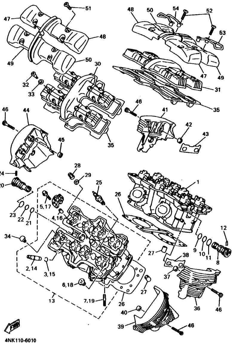
FIG. 1 CYLINDER HEAD
