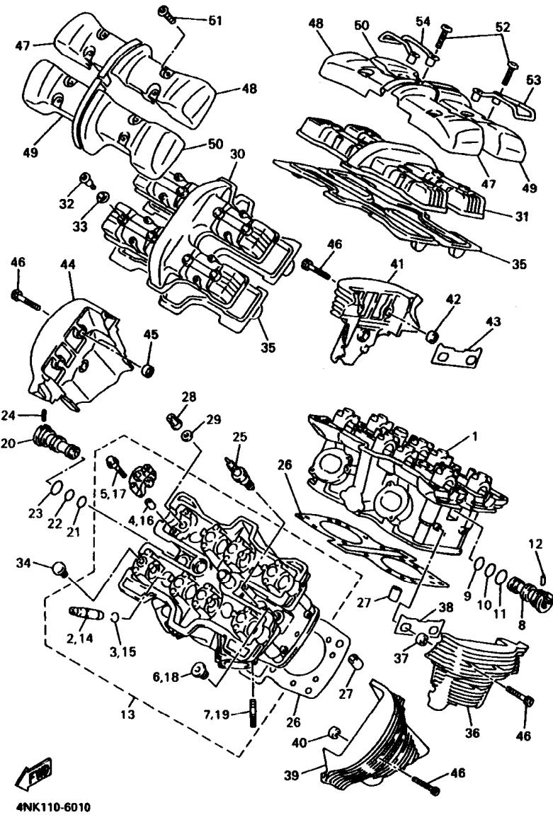
**FIG. 1 CYLINDER HEAD**
