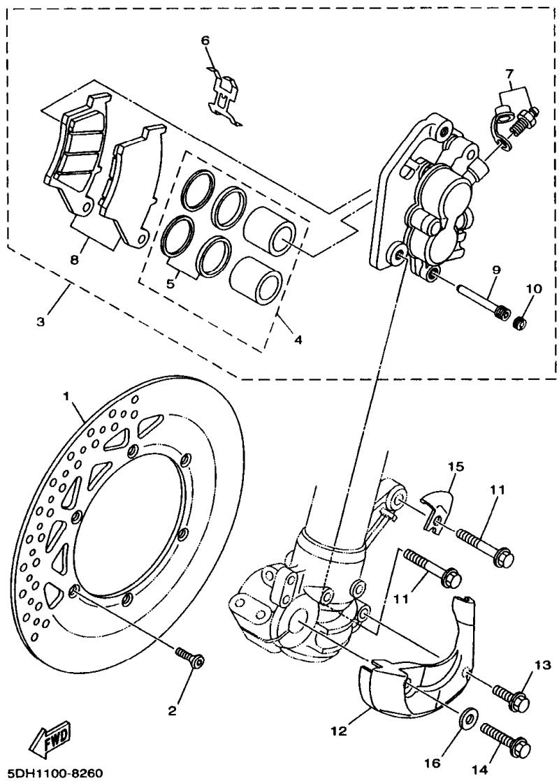
FIG. 26 FRONT BRAKE CALIPER
